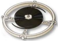
Wenn der Aussendurchmesser des Federhauses bekannt ist, kann der Innendurchmesser  $D_1$  berechnet werden. Bei der Dicke der Wandstärke muss die NIHS Norm 10-02 berücksichtigt werden. Die Sicherheit zwischen dem Zahngrund und dem Aussendurchmesser muss mindestens 0.03mm betragen.
